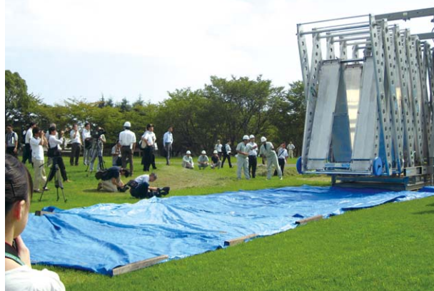
ブルーシートを川に見立て、橋を展開
