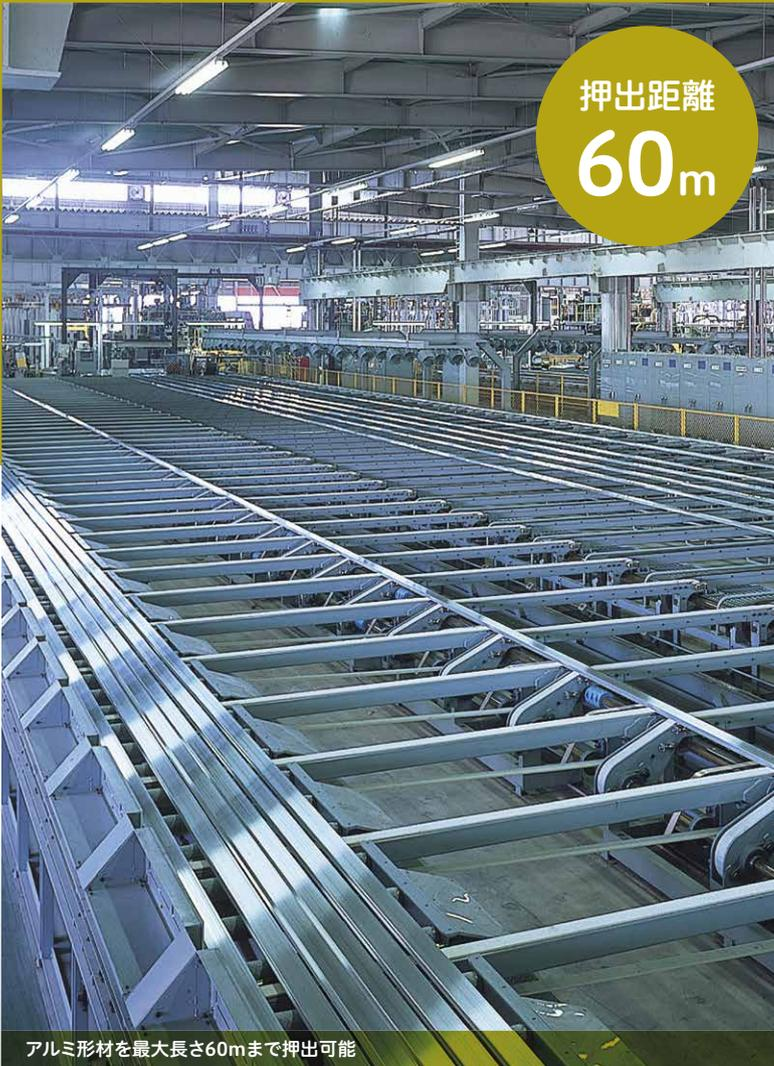
アルミ形材を最大長さ60mまで押出可能
