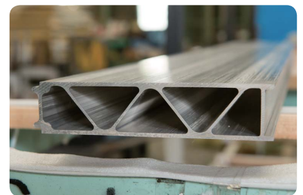
ダブルスキン形状の押出型材
